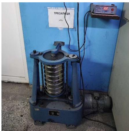
Ударно-ротациона тресалка за суво просејување
