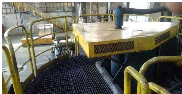
Б) Флотациска ќелија во погон флотација
