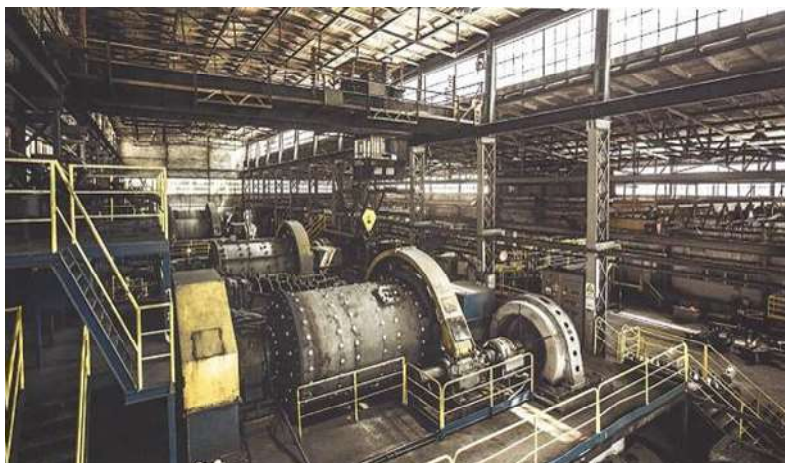
Слика 20 Изглед на одделението за мелење и класирање
