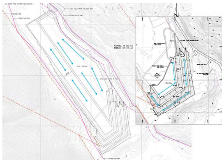
Слика 37 Правци на распростирање и набивање на јаловината
