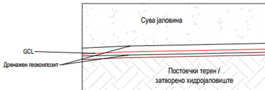
Слика 47 Обложување на основата на Инсталацијата за суво одлагање
