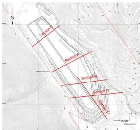
Слика 36 Ситуационо решение на инсталација за суво одлагање во рудник CASA
